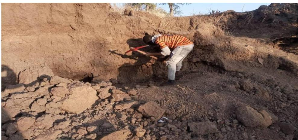
**Figure 19: Extraction des minerais sablo argileux par un fabricant des briques de terres cuites**
