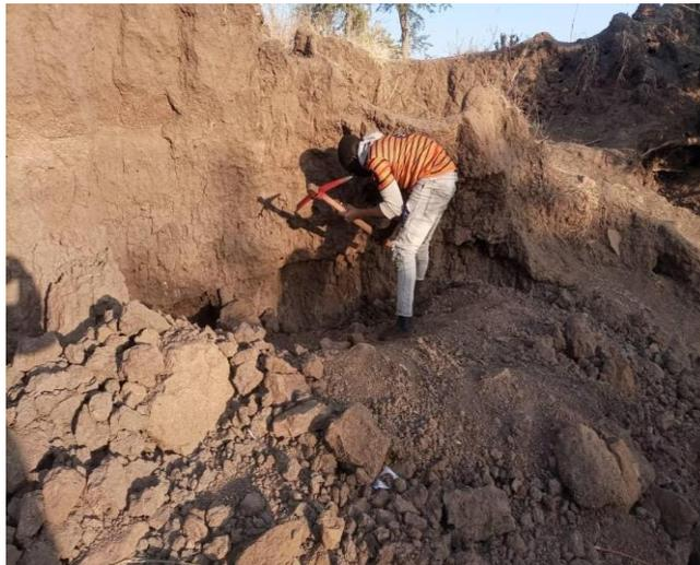
**Figure 27: Décapage d'une berge du Mayo Pitoa par un fabricant des briques**
