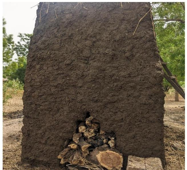
**Figure 32: Arbres introduits dans un four pour la cuisson des briques**
