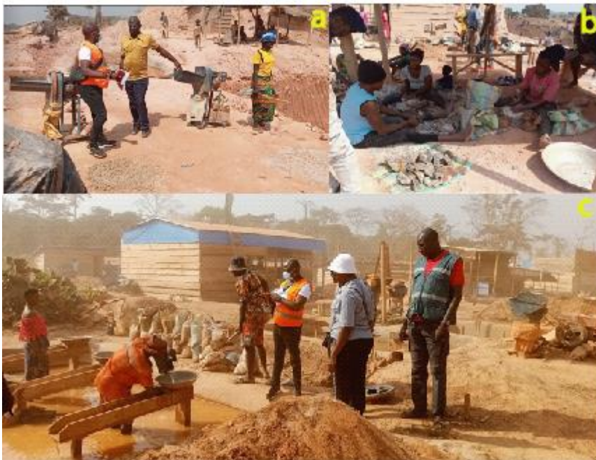
Figure 3. Broyage des graviers minéralisé par les machines de taille centimétrique et Concassage manuel par les femmes pour l'extraction hydraulique
