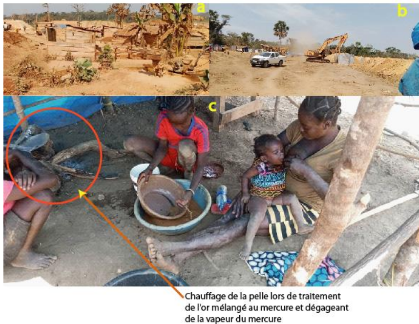
Figure 16. Pollution de l'air avec la vapeur de mercure lors de chauffage
