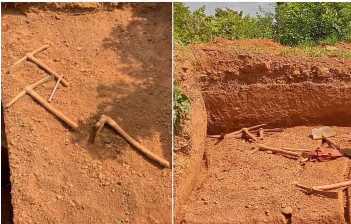
Figure 6 : Matériels utilisés pour la fabrication de briques latéritiques taillées
