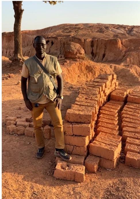
Photo 41 : Modèle de brique confectionné avec les argiles, site de Boromo3
