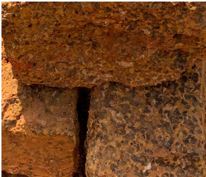
Photo 11: Intensité de l'oxydation (tâches noires) dans une BLT de Diébougou (SRK IMG\_2523)
