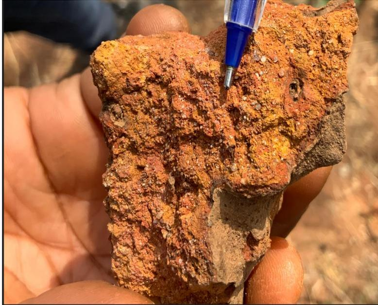
Photo 17: Grains de quartz abondant dans un échantillon de latérite (site de Bandougouya – Toussiana 4, Photo IMG\_1792)
